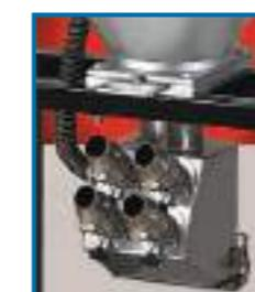
Valvole di fluidificazione per silos e tramoggi
