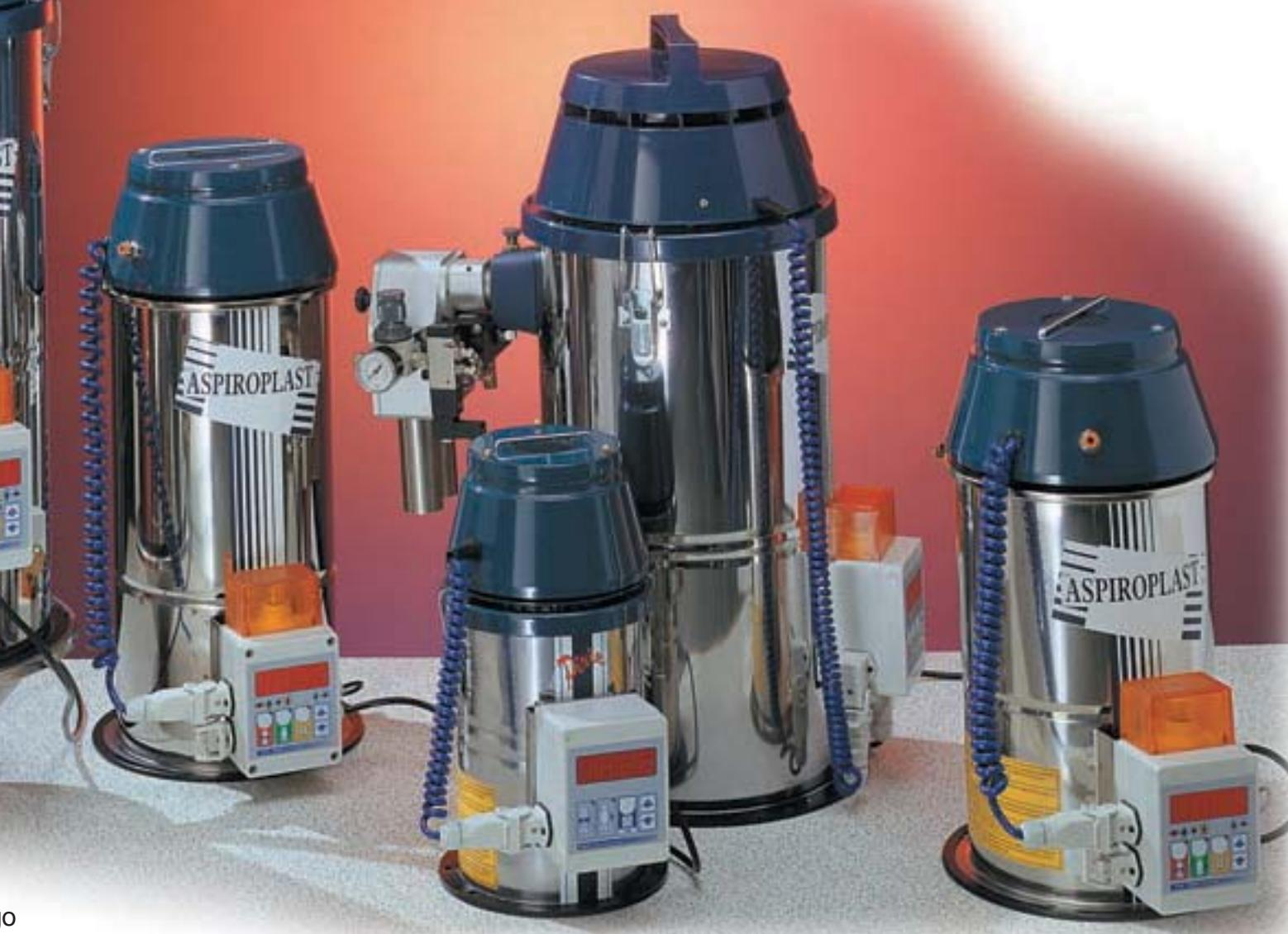
I nostri alimentatori monofase serie AS, sono dotati di scheda di comando che permette secondo i modelli la regolazione dei parametri (sosta, carico, pulizia filtro, valvola proporzionale), con la segnalazione degli allarmi di mancata carica, pulizia filtro e sostituzione carboni motore.
