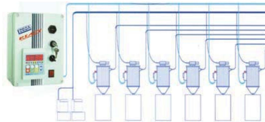
Basterà poi collegare con un semplice cavetto twinex una macchina all'altra, installare una turbina, le tubazioni per creare la depressione, e le tubazioni del materiale, e l'impianto è pronto a funzionare, senza avere sprecato nulla.
