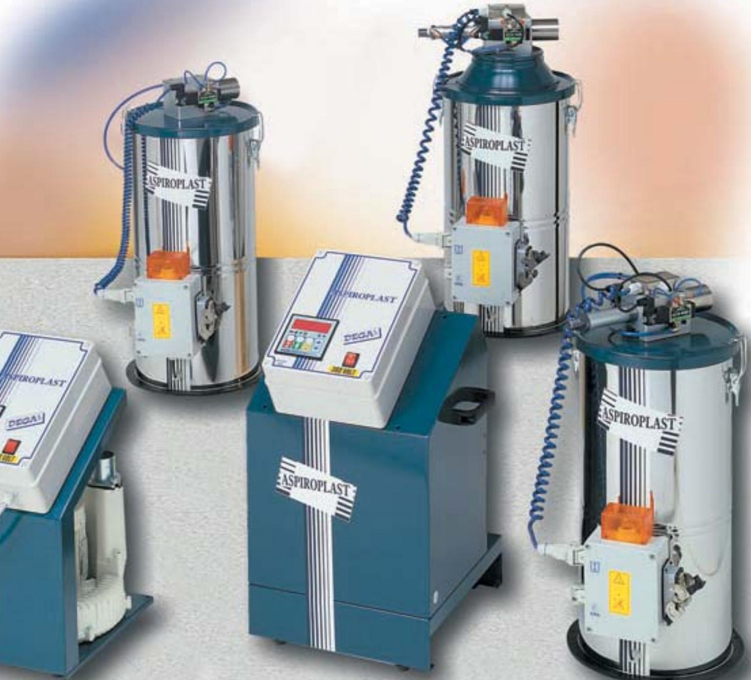
Il quadro di comando degli alimentatori serie AT è posizionato a terra sul box di protezione della pompa. La scheda di controllo permette secondo i modelli la regolazione dei parametri, sosta, carico, pulizia del filtro, valvola proporzionale con la segnalazione di mancata carica, pulizia filtro, ispezione cuscinetti, alta temperatura e blocco termico pompa.
