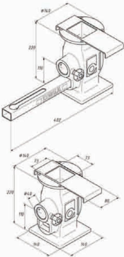
Base di fissaggio unificata pronta in stock costruita in alluminio pressofuso, con serranda di chiusura in acciaio.
