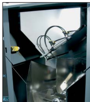
Trémie de pesée Weighing bin
