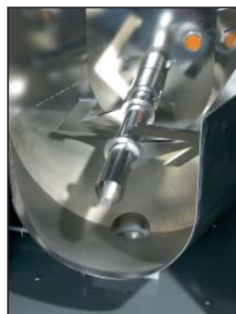
Cuve de mélange biconique Biconical shape mixer
