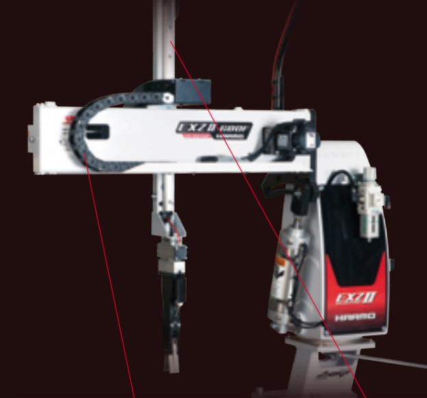
La chaîne de câble sur l'axe horizontal protège le câblage et les tuyaux. Le mouvement fluide donne l'apparence élégante d'un robot.
