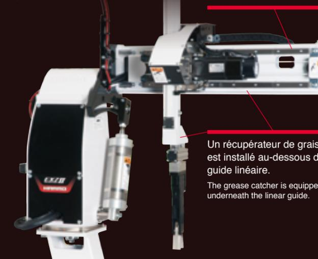
Un récupérateur de graisse est installé au-dessous du guide linéaire.
