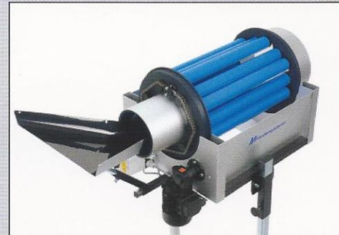
Optional mit geregelter Drehstromantrieb für stufenlos einstellbare Trommeldrehzahl
