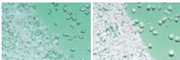
PMMA (polyméthacrylates de méthyle) POM (polyacétal)
